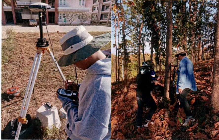
รูปที่ 4 การรับวัดด้วยเครื่องรับวัดตำแหน่งดาวเทียม GNSS
